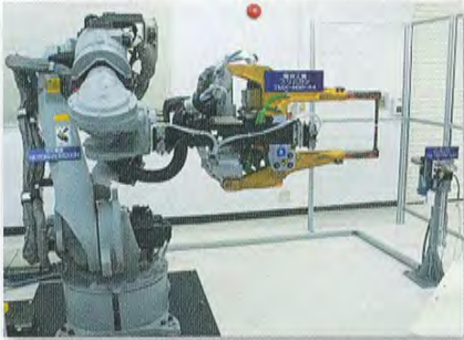
スポット溶接ロボットとチップセーバー
