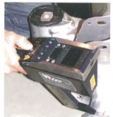
サーボロボット社 ポータブル溶接検査システム
